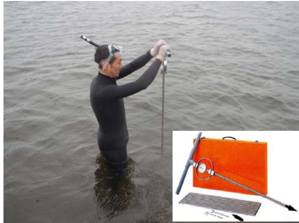
図Ⅲ.2.1-13 コーンペネトロメーター計測状況
