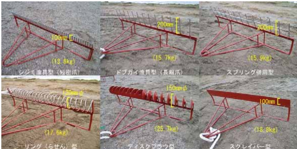
図Ⅲ.2.2-11 テスト用に試作したマンガ型耕うん器の例 (桁枠の幅はいずれも 1.4m).
