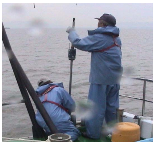
図Ⅲ. 2. 3-16 湖底硬度測定の様子
