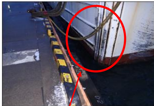
岸壁への接触による 漁船船体の損傷
