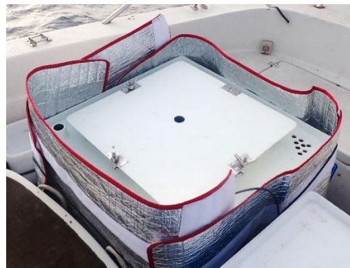
図 3. 250L FRP 製断熱水槽
