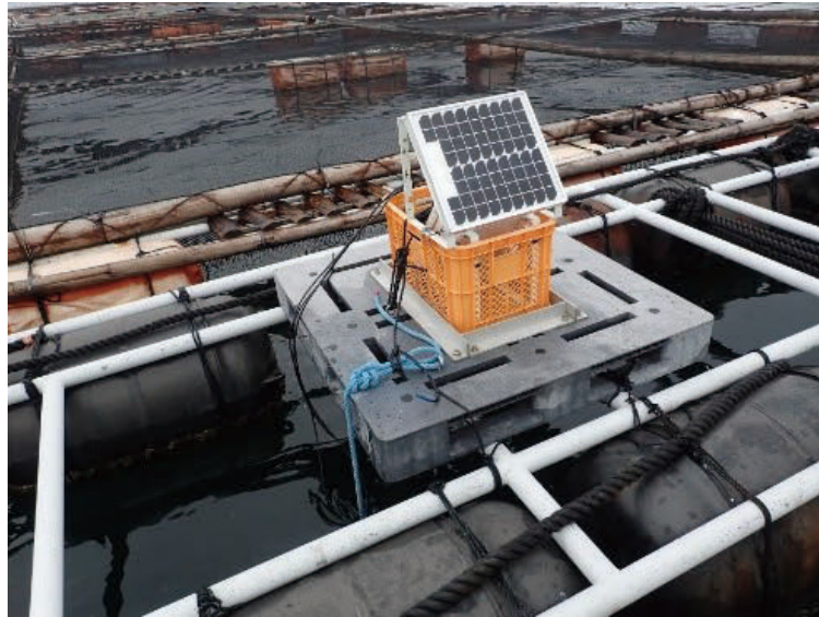
図 4. 楠浦湾設置のテレメータ
