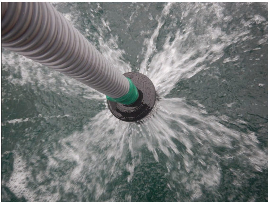
図3 高濃度酸素水の吐出状況
