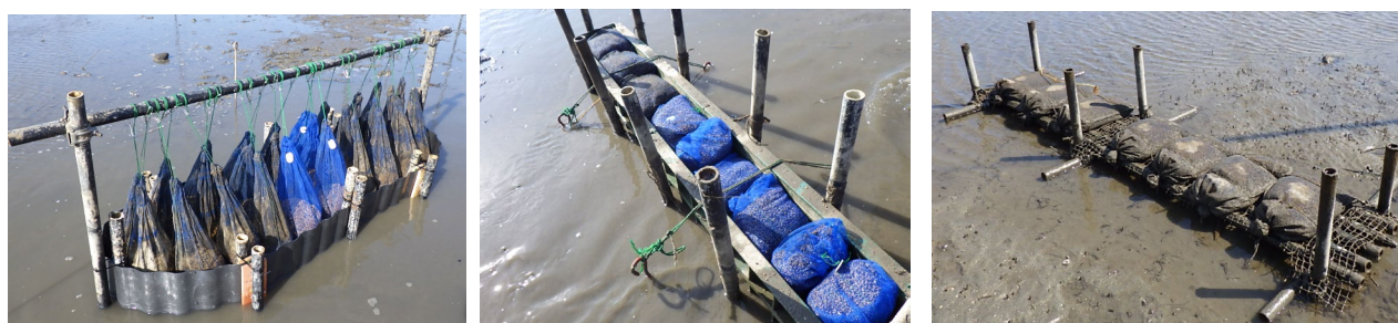
図 27 畔板(左)、プランター(中央)、及び網袋(右)の設置状況(豪雨後)
