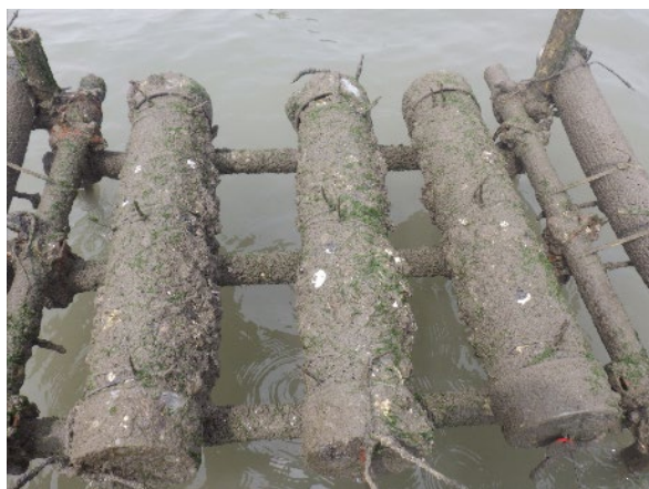
図 35 ネットロンパイプにおける付着状況と基質の状態（2025 年 5 月 28 日 305 号地区）
