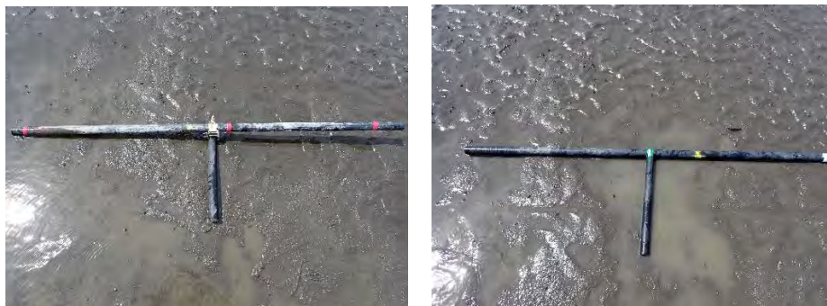
図 39 T字型離底器の構造例
