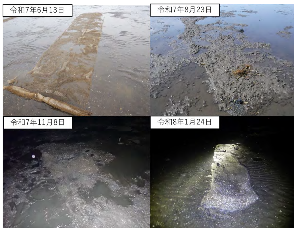
図 20 被覆網（切り替えなし）の経時変化
