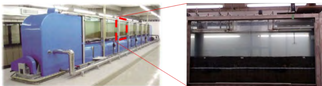
図 31 大型回流水槽（右写真は実験で使用する約 2m の観測区間）
