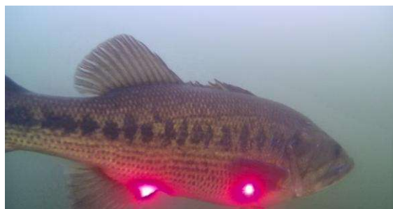
図 4 レーザースケイラーによる体長推定
