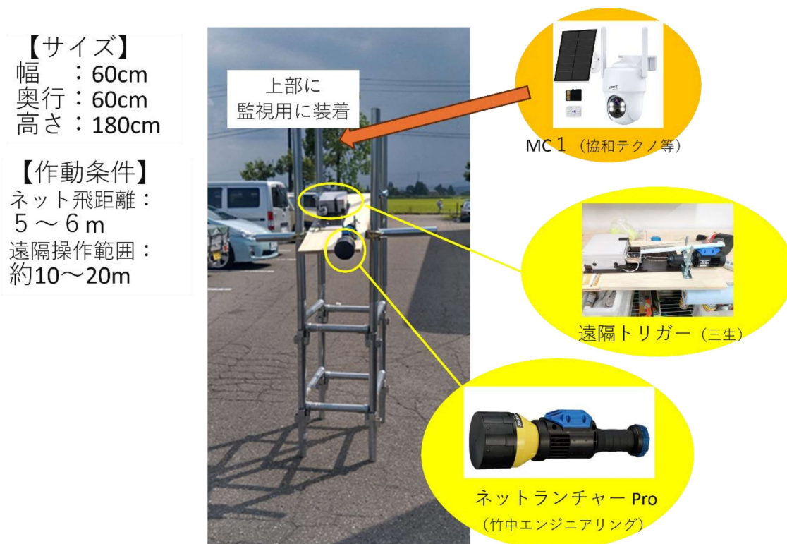
図 7. ネット捕獲の発射装置（試作機）の構造と仕様
