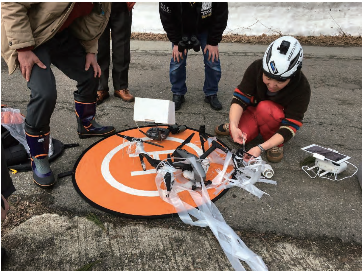
図 8. ビニルテープが絡まり、ドローンが落下した直後の様子
