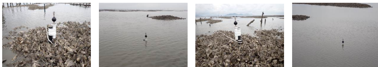
図 44 流速計の各地点設置状況
