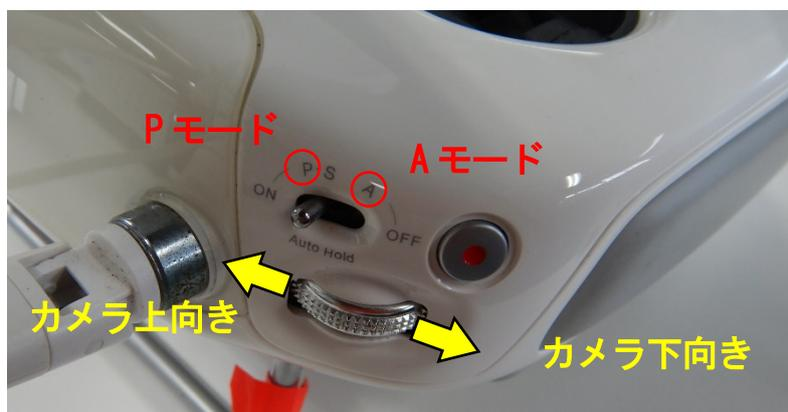
図 6 カメラの向き、モードの切り替え
