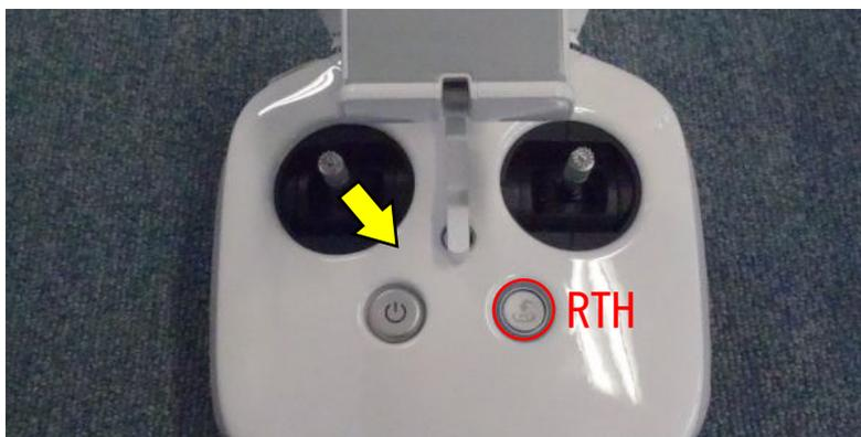
図 7 モーターの緊急停止
