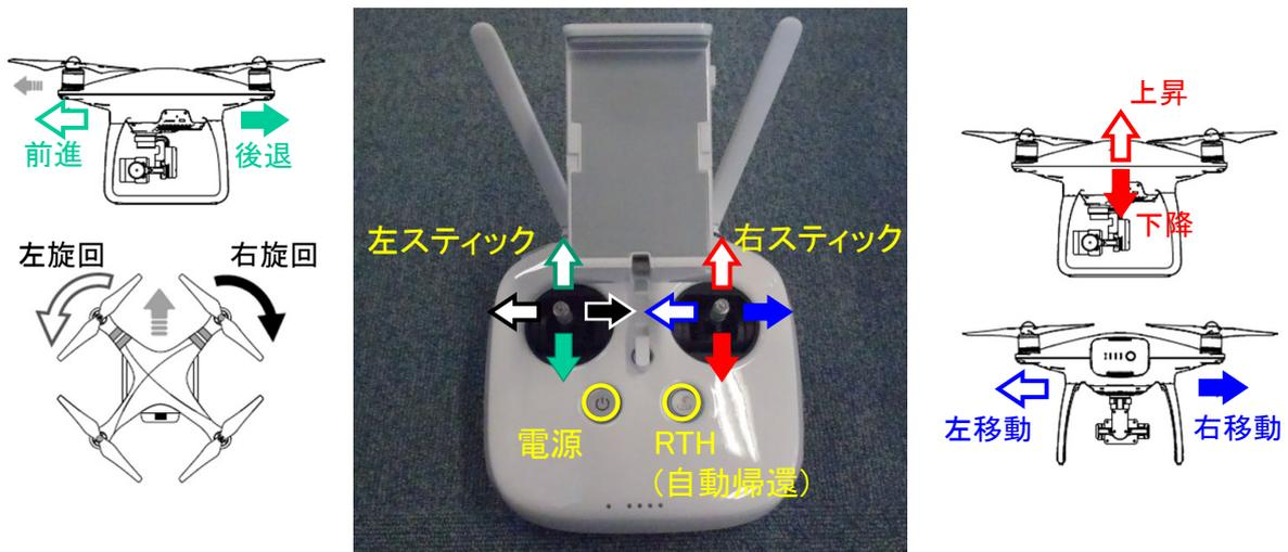
図 4 ドローンの基本操作方法
