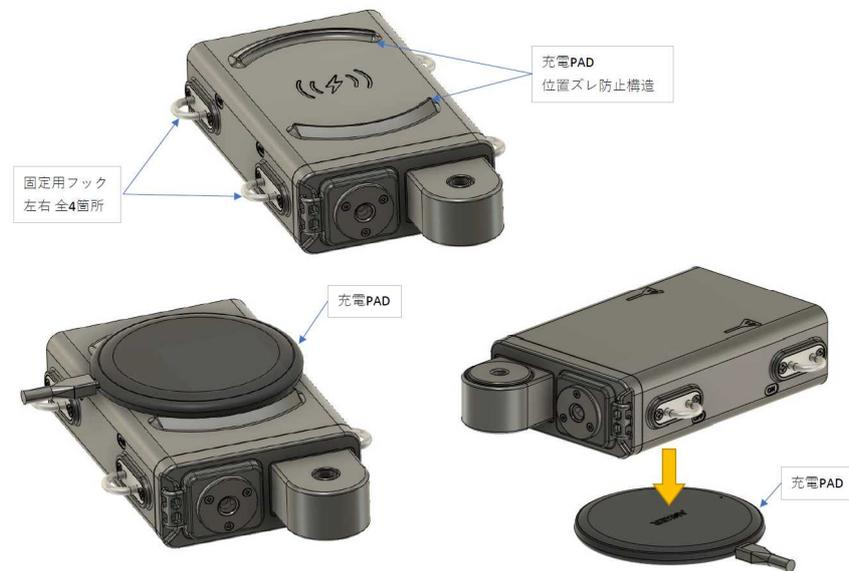
図9. 完成した IoT ロガー。高精度深度センサー、温度センサー、塩分センサー、溶存酸素センサー、GPS を搭載。観測データはクラウドへ自動送信され、数分以内に図表となったデータがデジタル操業日誌(受信機)へ送られてくる。
