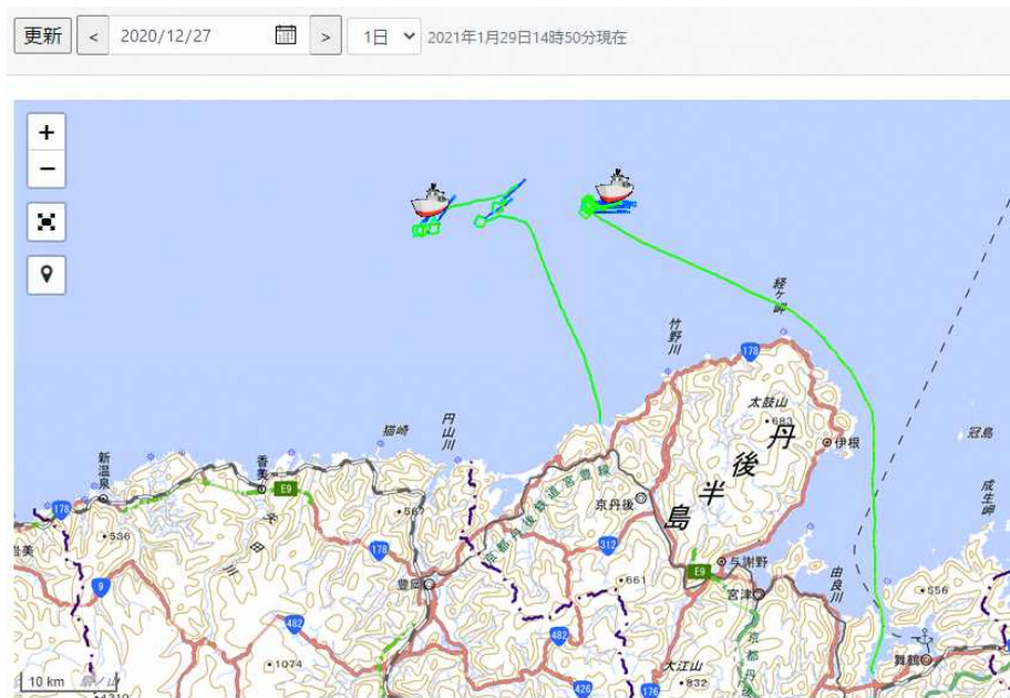
図10 データロガーシステムによる操業情報収集例(航跡)
