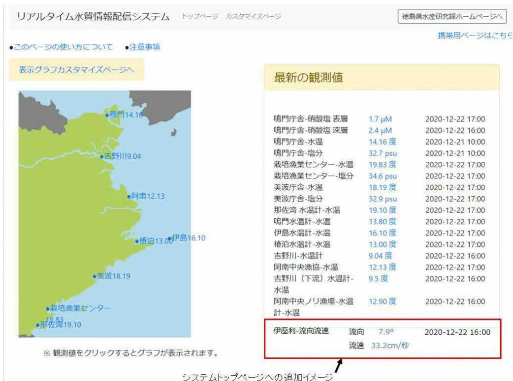
図1 システムトップページの改修（流向、流速の追加）イメージ
