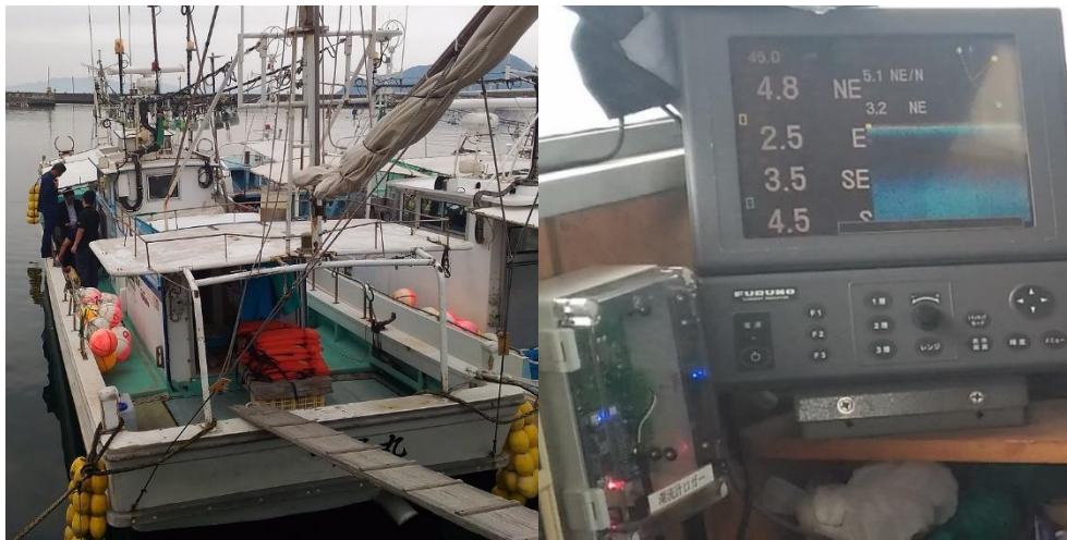
図 11-4 2017 年 5 月、福岡県宗像市（鐘崎漁港）の小型漁船に NMEA（漁船電子信号）データロガーを取り付けた。
