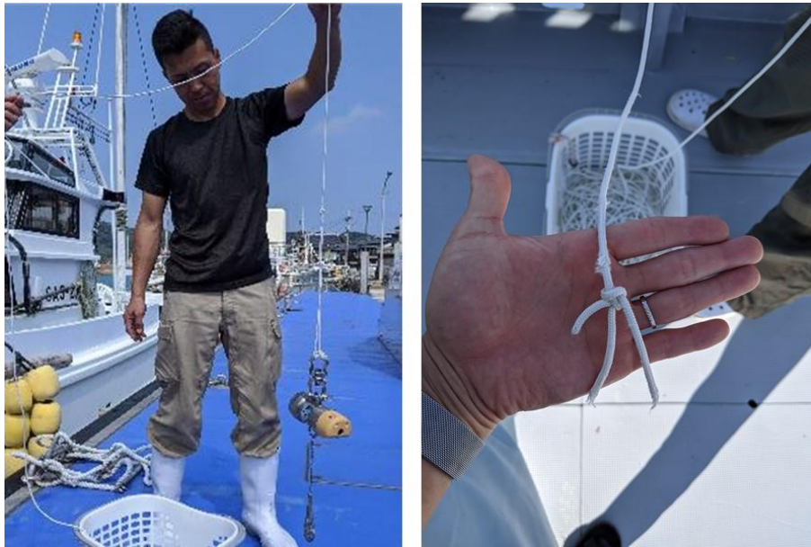
図 34-4 観測用ロープと S-CTD の連結状況（左図）と観測用ロープが切断された状況（右図）。
