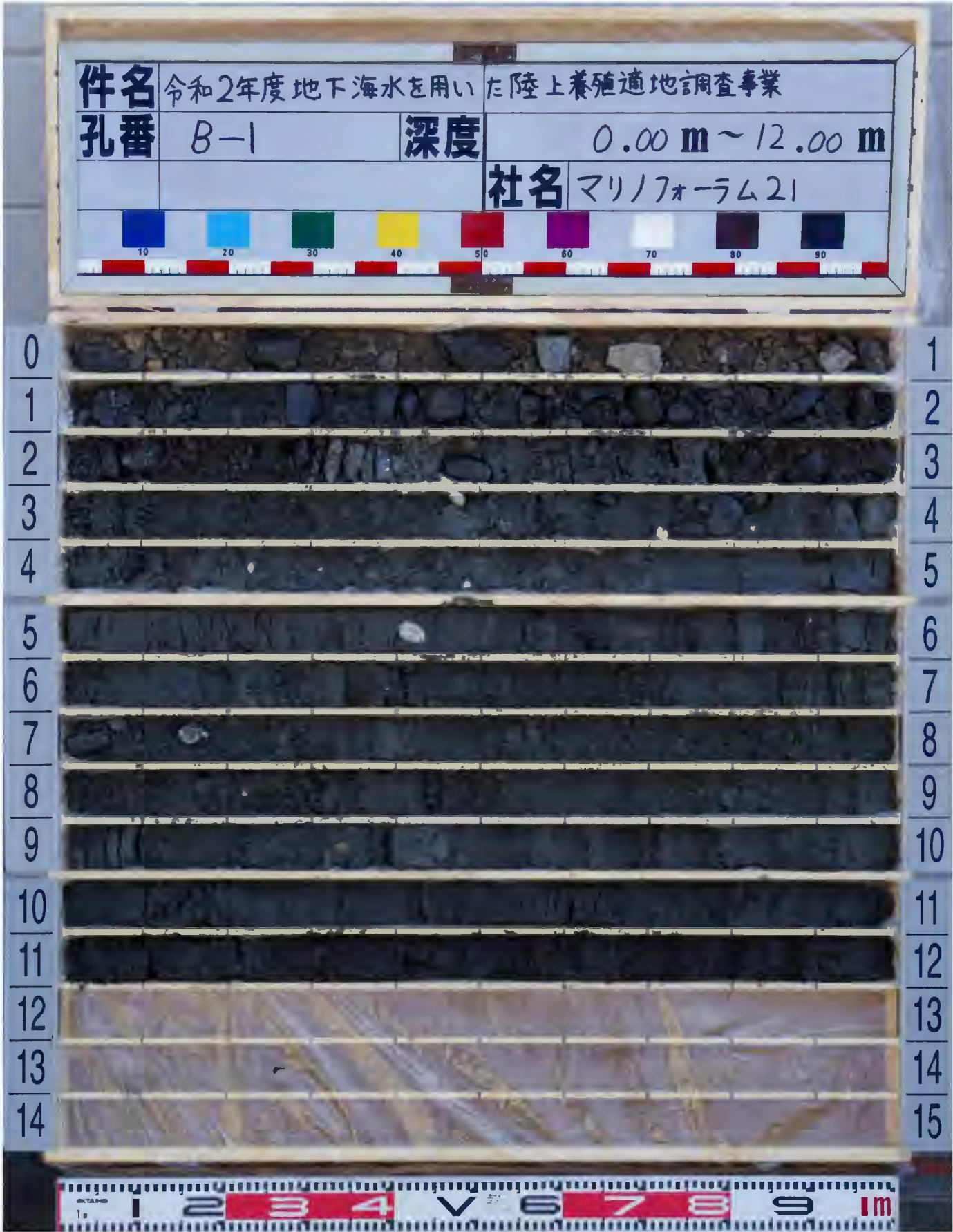
図4-7 ボーリング柱状図及びコア写真
