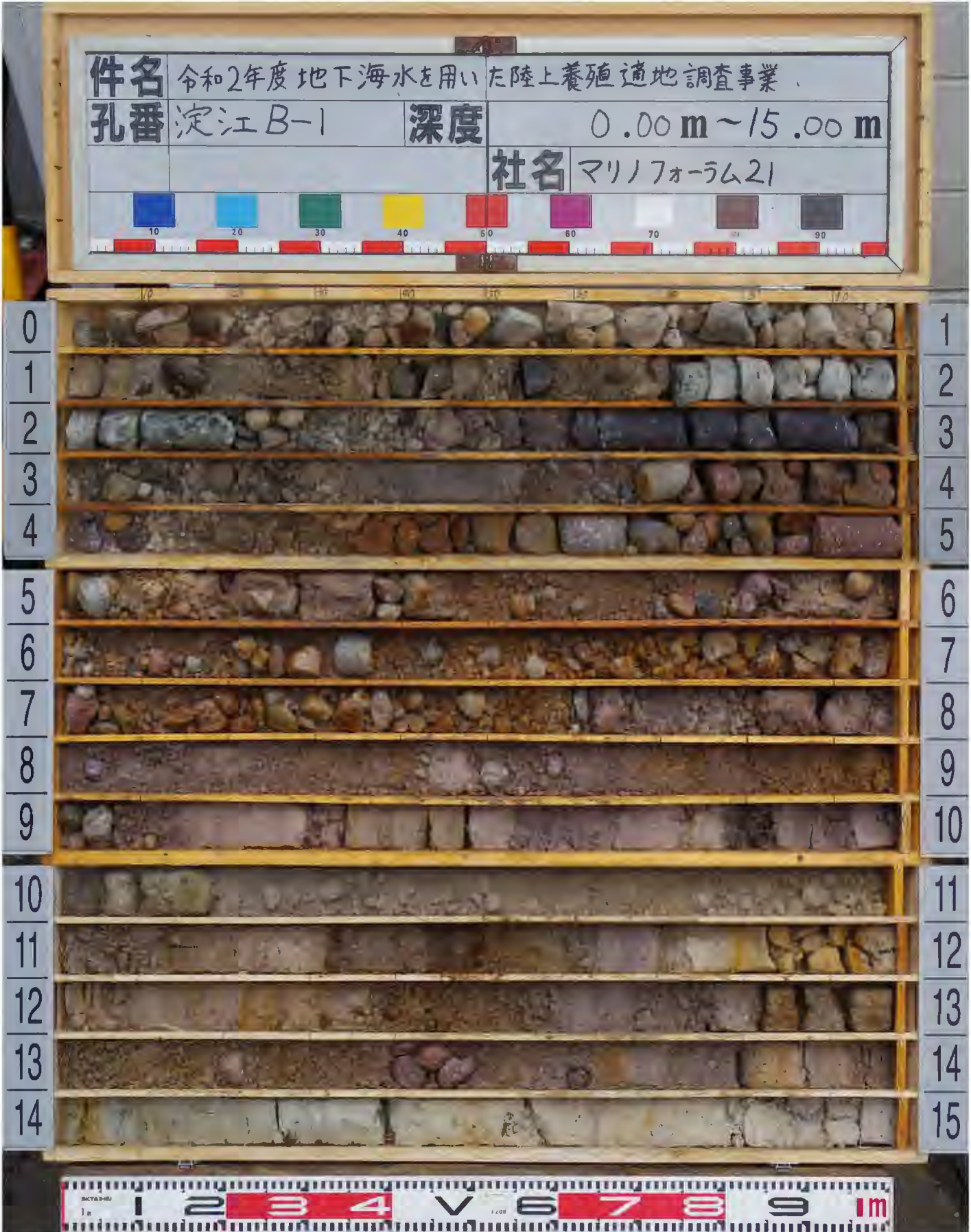
図5-6 ボーリング柱状図及びコア写真
