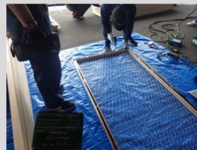
図 34 棚式着生材の製作手順 (1/2)
