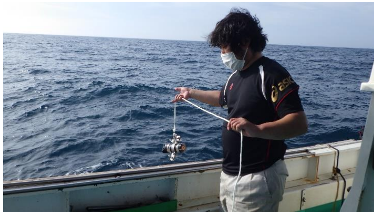
図 12-2 多数の漁業者試験を経て、小型で簡便な無線 CTD が完成した。
