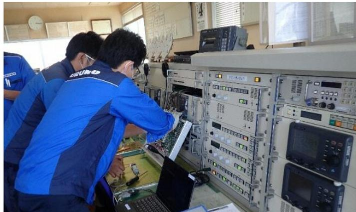
図 33-3 境港通信局で行われた安全情報伝達システム CS-160 導入作業
