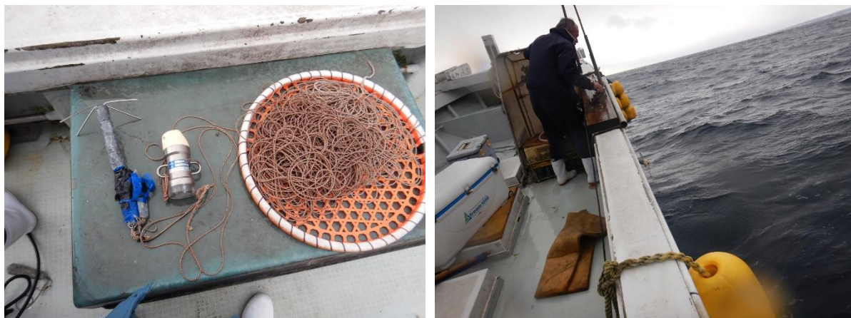
図 34-14 S-CTD のはえなわ漁具への取り付け
