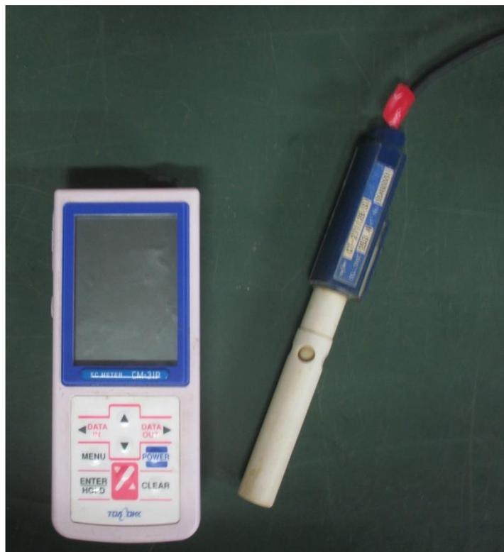
図 2-8 ポータブル電気伝導率計
