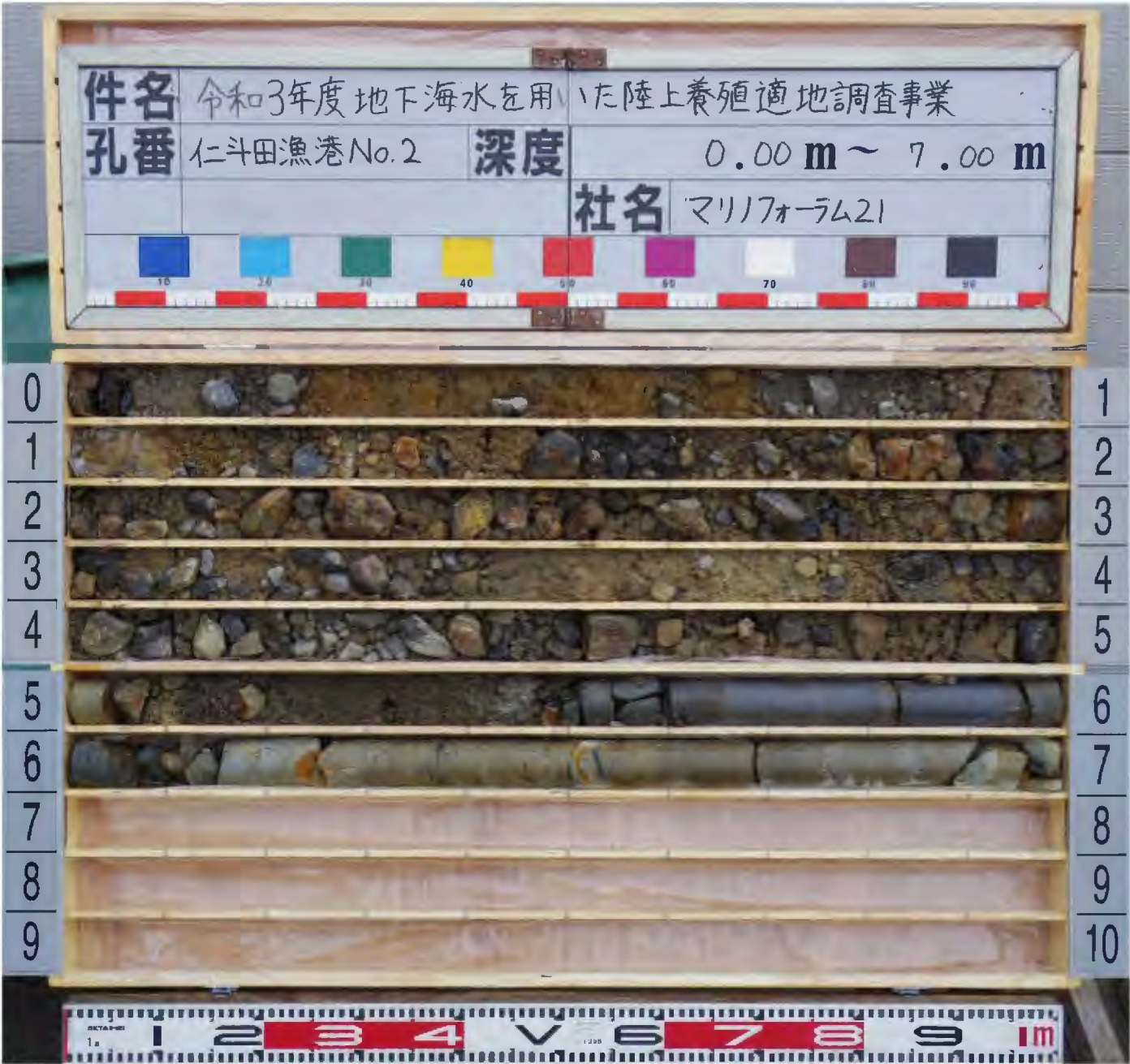
図 3 - 8 ボーリング柱状図及びコア写真 (仁斗田No. 2 孔)
