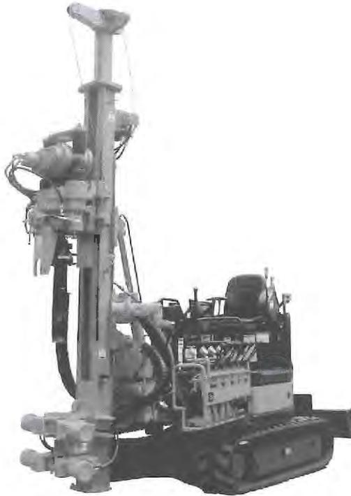
図 4-5 振動式装置の例<sup>30</sup>
