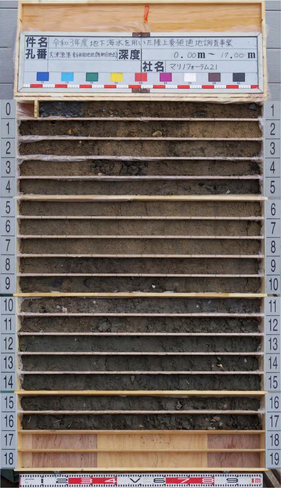
図4-11 ボーリング柱状図及びコア写真 (B地点)
