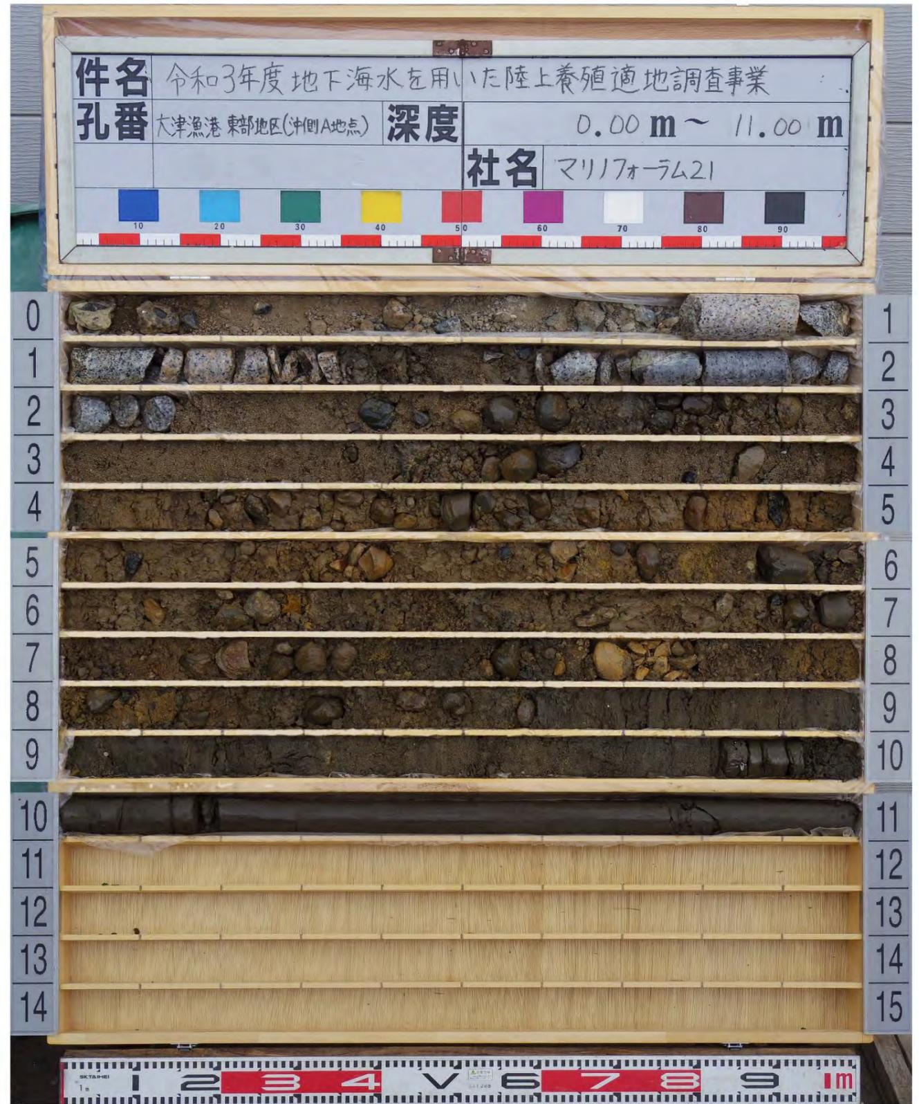
図4-9 ボーリング柱状図及びコア写真 (A地点)
