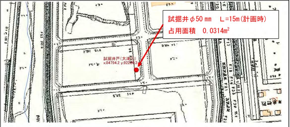
求積図（試掘井 VP50） 縮尺 1 : 10
