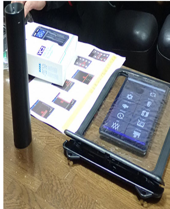
図1 (3) -2 令和2年度に構築した底びき網用ロガーシステム
