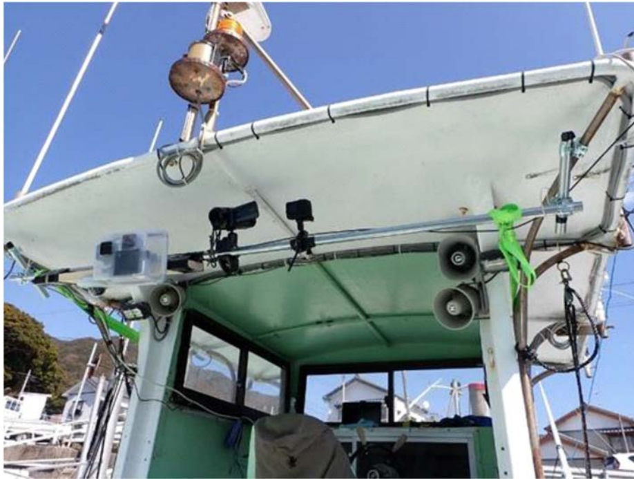
図1 (5) -6 A機、B機、D機の設置位置
