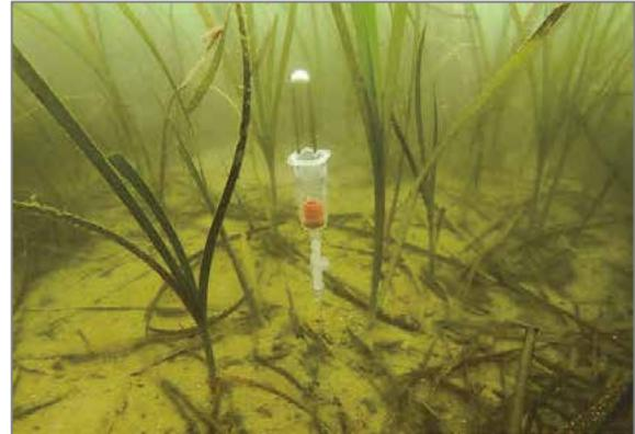
図2 砂泥中の間隙水を採取する採水器
