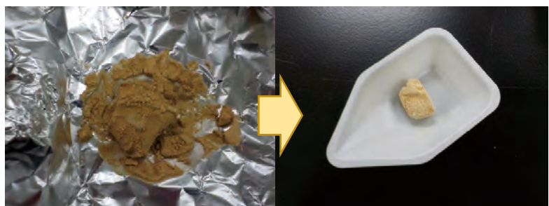
図9 改良固形型⑤ (左:乾燥時, 右:添加時は削って形成)
