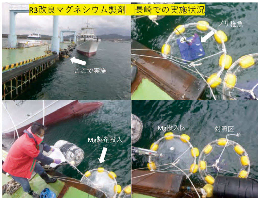
図 32 新長崎漁港内における散布試験の実施状況
