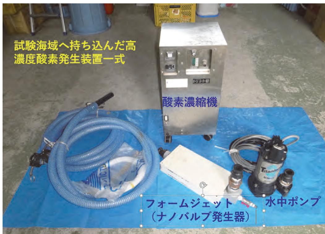
図1 高濃度酸素発生装置一式
