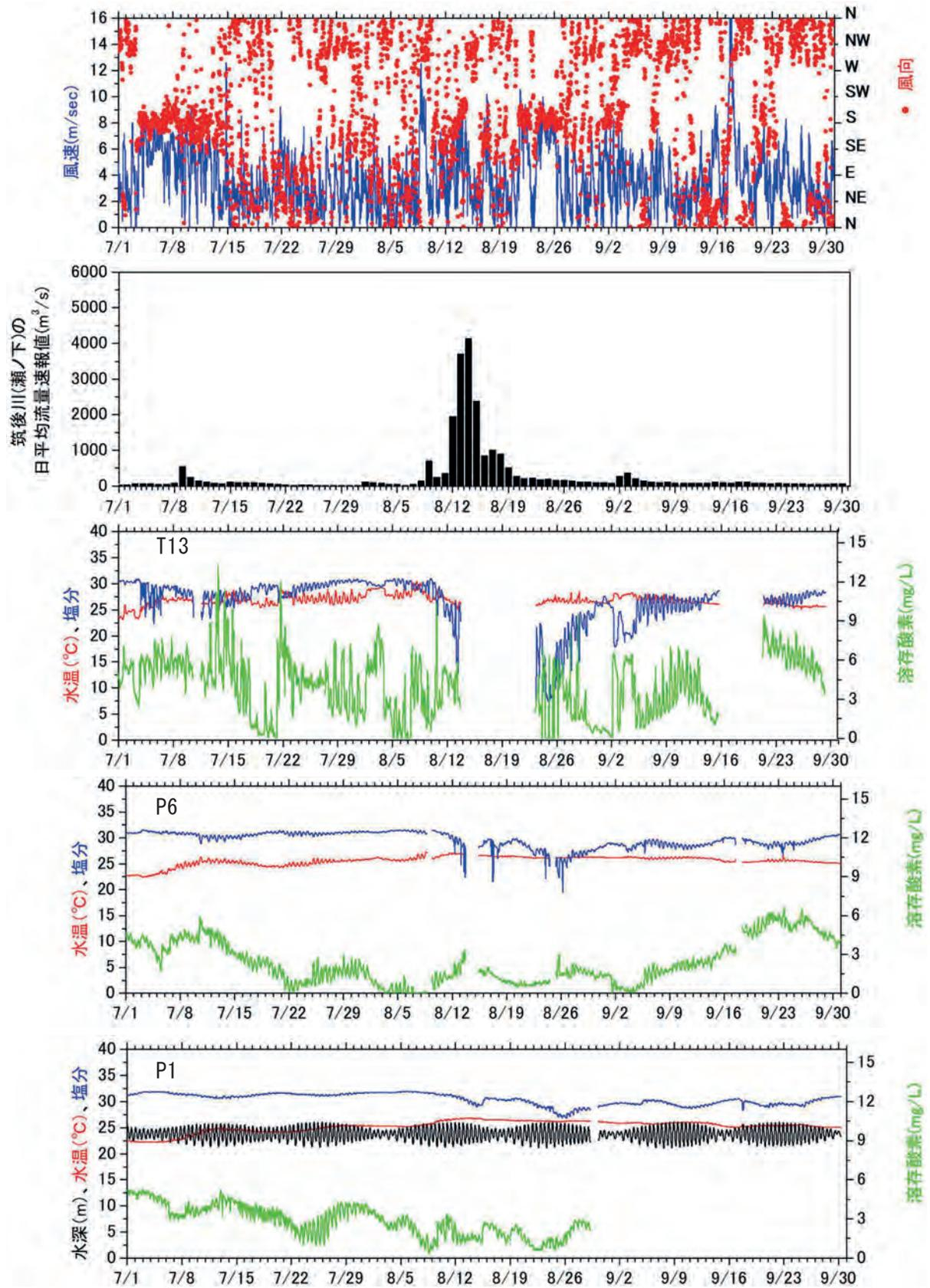
図 1-1-2. 沖神瀬西ブイの海上風(海面から3m)の風向・風速(3時間毎の10分平均値)、筑後川(瀬ノ下)の日平均流量、T13、P6及びP1の底層水温(海底面から0.2m)、塩分、溶存酸素、水深の時間変化
