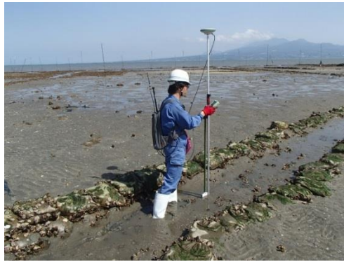
図 8 地形調査 (RTKGPS) 作業状況
