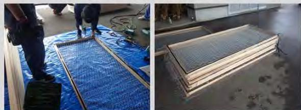
図 34 棚式着生材の製作手順 (1/2)
