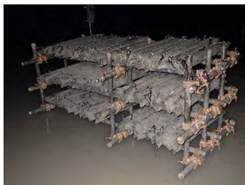
図 40 架台の設置状況(設置3か月後)
