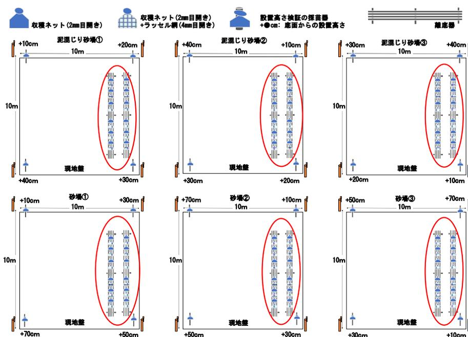
図25 保護方法の比較実験における採苗器の設置位置
