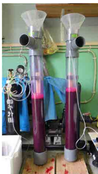
図 3. 作成した大量染色用器で染色中のワカサギ卵
