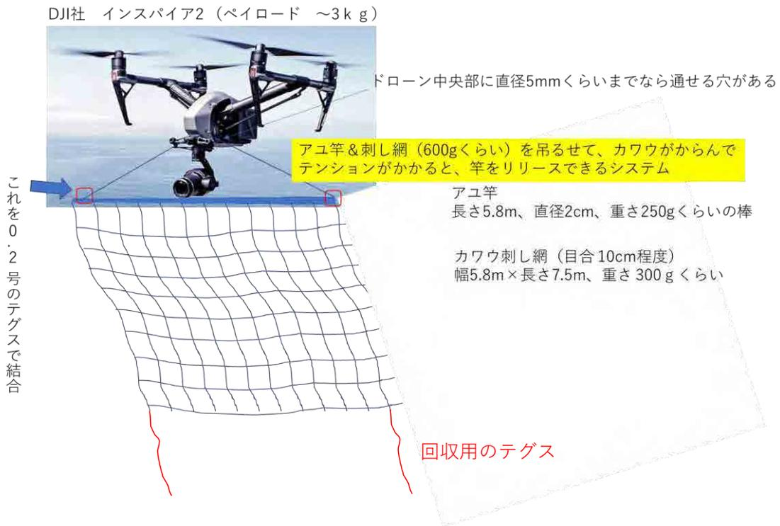
図1. カワウを捕獲するための仕組み
