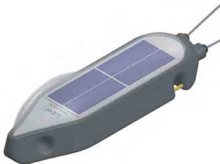
図-1 カワウに GPS ロガーをハーネスで装着した様子（上）と本研究で使用した GPS ロガー（下）（Solar PinPoint VHF-L Tag、Lotek 社製）
