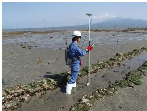
図 8 地形調査 (RTKGPS) 作業状況
