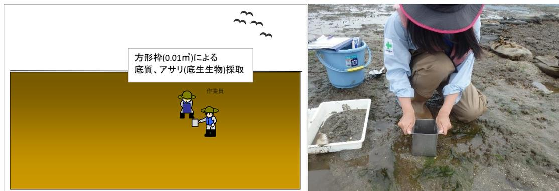
図 11 底質調査・生物調査 作業状況
