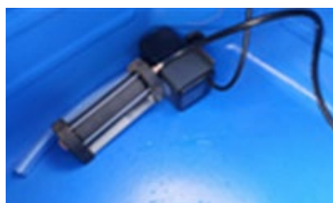
図10 活魚水槽の水流用ポンプ
