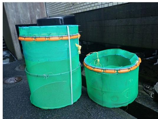
写真 製作した囲い網
