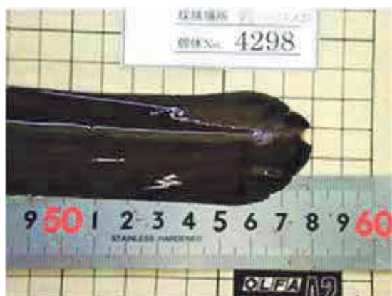
写真 1 尾部先端の欠損（軽度）
