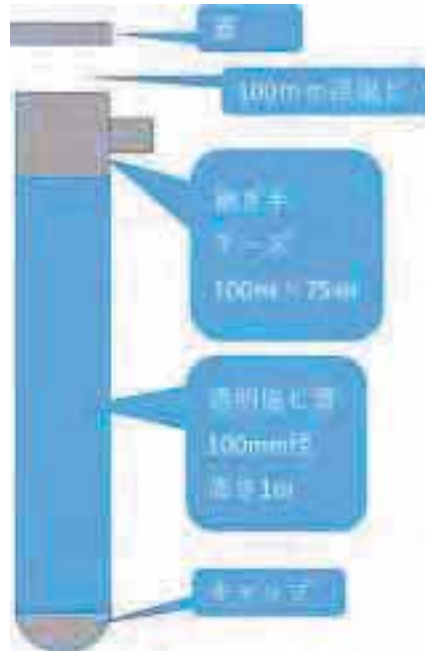
図2. 自作染色容器での染色と染色容器の構造
