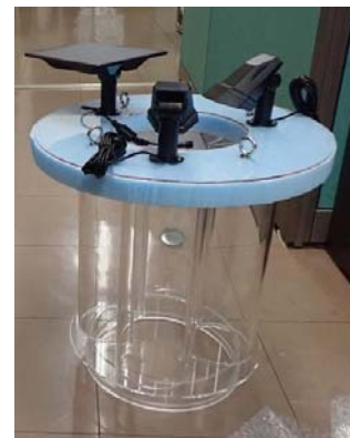
図 13 谷沢トラップ（アクリル 下部にネットを設置して使用）
