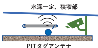
図15 東北地方等で新規の調査地点を設定する際の作業工程。2022年度にウナギの降海期と考えられた9月中旬以前に一定数の銀ウナギ候補をタグ標識し、各魚の分布域の経時変化を3次元マップのプラットフォームを用いて把握する。また、一定水深の狭窄部に設置したPITタグアンテナで通過タイミングを把握するとともに、水中カメラで銀ウナギか否かの確認を行う。
