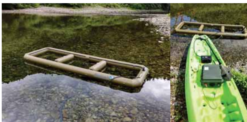
図 1 1 フロート式 PIT タグアンテナの試験運転の様子。
